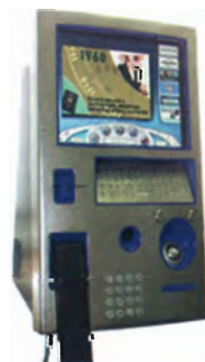
Рис. 9. Карточный web-таксофон фирмы Siemens Elasa (Испания) с помощью которого возможно предоставление услуг традиционной голосовой связи, доступ к ресурсам Интернет, доступ к электронной почте, отправка SMS-сообщений и электронных фото- и видеозаписей, размещение интерактивной рекламы. Первые 10 Web-таксофонов размещены в Российской Экономической Академии им. Плеханова, гостинице Центрального Дома Туриста, Российском Университете Дружбы Народов, на Павелецком вокзале (Терминал «Домодедово»), в развлекательном центре «На Тульской», торговом комплексе «Золотой Вавилон» и т.д.
