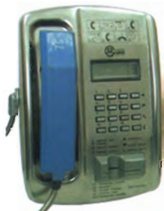
Рис. 6. Карточный таксофон ТМГС-15280М. Совместное производство фирм AMPER (Испания) и ТЕЛУР (Россия, г.Пермь). В эксплуатации с 1997г. ОАО МГТС приобретено 2750 аппаратов
