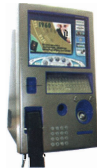
Рис. 9. Карточный web-таксофон фирмы Siemens Elasa (Испания) с помощью которого возможно предоставление услуг традиционной голосовой связи, доступ к ресурсам Интернет, доступ к электронной почте, отправка SMS-сообщений и электронных фото- и видеозображений, размещение интерактивной рекламы. Первые 10 Web-таксофонов размещены в Российской Экономической Академии им. Плеханова, гостинице Центрального Дома Туриста, Российском Университете Дружбы Народов, на Павелецком вокзале (Терминал «Домодедово»), в развлекательном центре «На Тульской», торговом комплексе «Золотой Вавилон» и т.д.
